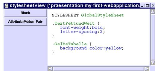
Zur Positionierung und Formatierung von Elementen einer Webseite können in der Stylesheet-Sicht Stylesheetblöcke definiert werden. Diese können den Elementen von Webseiten zugeordnet werden.
